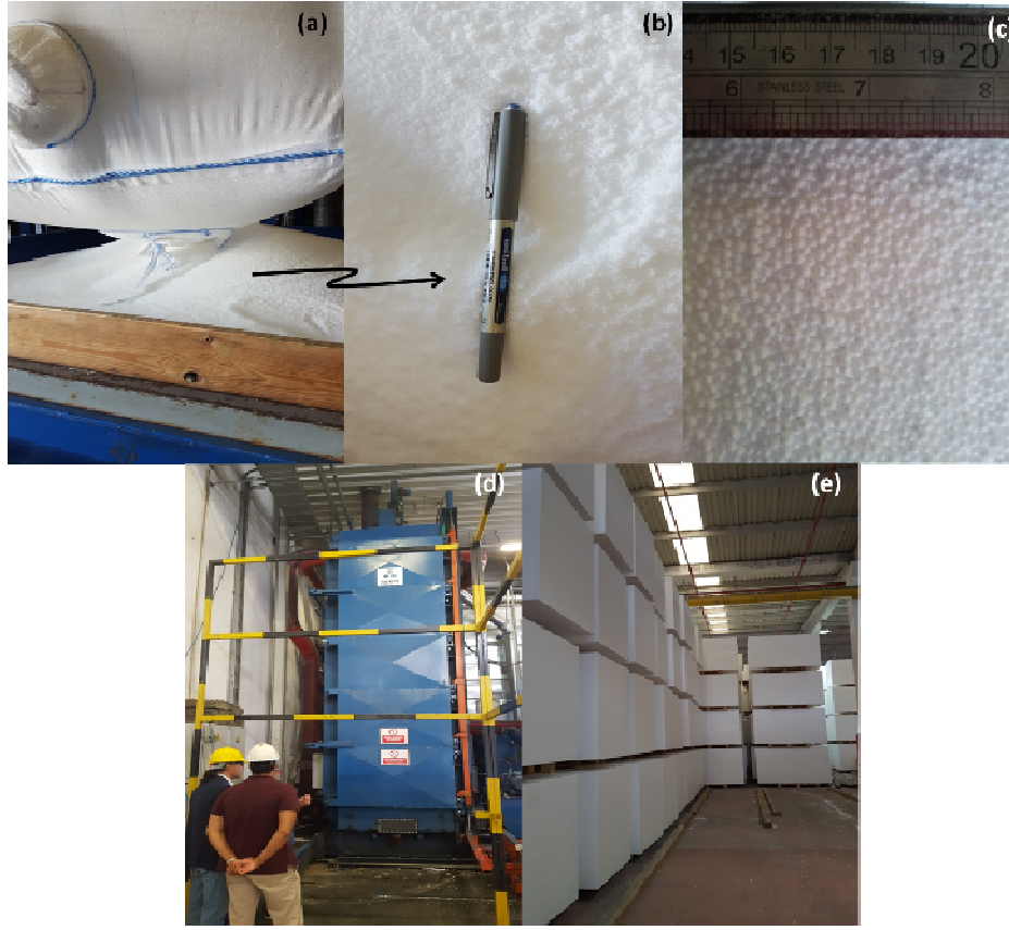
Şekil 1. EPS blok üretim aşamaları (a-b) 0.2 – 0.5 mm çapında polistiren hammadde (Yer: Austrotherm, Dilovası/Kocaeli; Fotoğraf: A. T. Özer, Tarih: 17.08.2016) (c) ön şişirme işlemi sonucunda elde edilen çapları 1 mm – 4 mm arasında değişen EPS boncuklar (Koç, 2015) (d) ön şişirilme işleminden sonra kalıp (Yer: Austrotherm, Dilovası/Kocaeli; Fotoğraf: A. T. Özer, Tarih: 17.08.2016) (e) imalat sonrası boyutsal kararlılığa erişmek için stok sahasında dinlendirilen geofoam bloklar (Yer: Austrotherm, Turgutlu/Manisa; Fotoğraf: A. T. Özer, Tarih: 11.02.2017)
